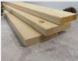
КАРКАС ИЗ ДОСКИ КАМЕРНОЙ СУШКИ
